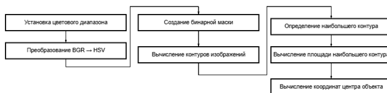
Рисунок 1: блок-схема алгоритма идентификации объекта
