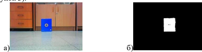
Рисунок 3: а) фото целевого объекта с отмеченным центром, б) бинарная маска изображения
